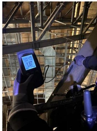
Medición de espesores de pintura.
