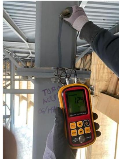
Ultrasonido medidor de espesores.
