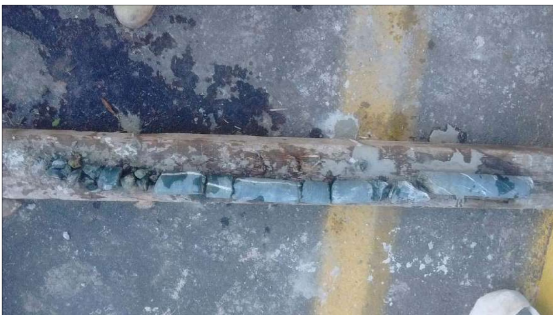
Otra muestra obtenida en el sondeo de penetración estándar SPE-1 (en roca)
