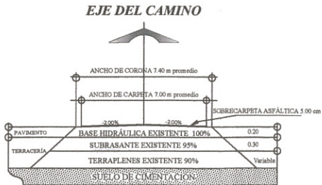
SECCIÓN CAMINO TIPO C REHABILITACIÓN
