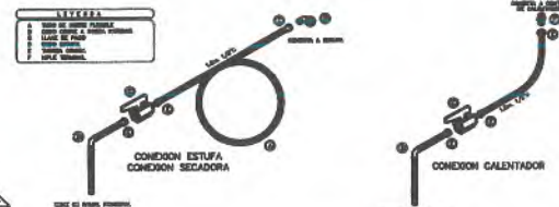
03 DETALLE DE CONEXION A MUEBLES DETALLES INSTALACION DE GAS ESCALA 3/4"
