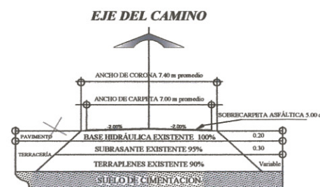
SECCIÓN CAMINO TIPO C REHABILITACIÓN
