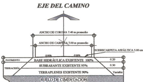
SECCIÓN CAMINO TIPO C REHABILITACIÓN
